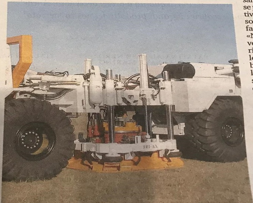
Uno dei mezzi che si utilizzano per i vibrosondaggi
